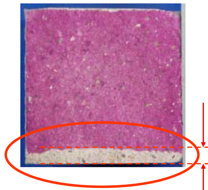
写真 - 10 中性化深さ測定の場合
