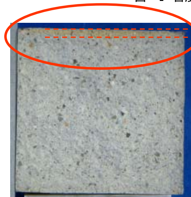
写真 - 5 含浸深さ側定の例
