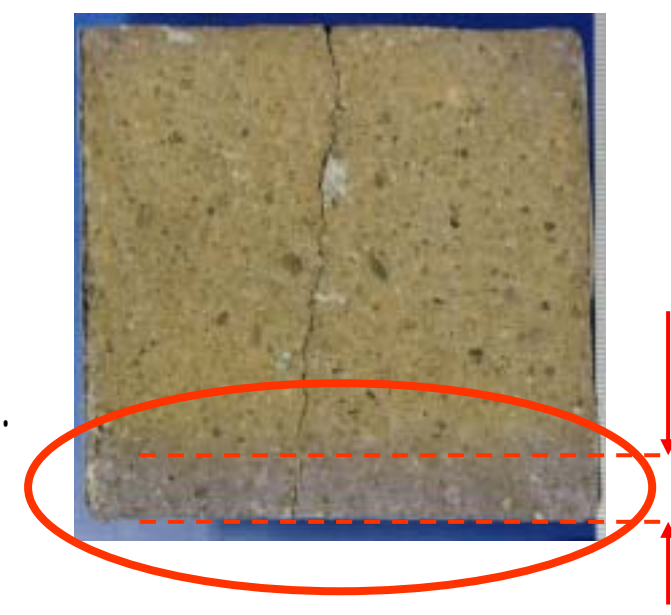
写真 - 11 塩化物イオン浸透深さ測定の場合
