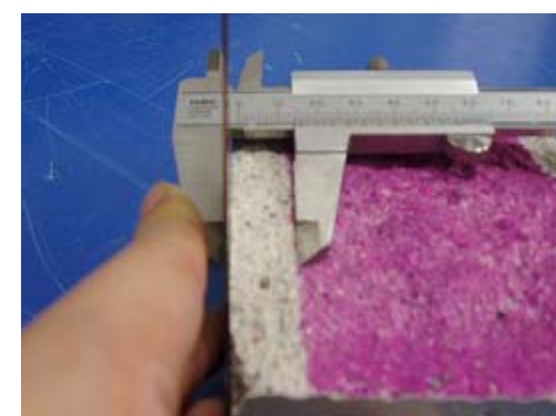
写真 - 2 中性化深さ測定状況
