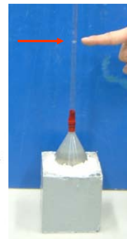
写真 - 6 透水量側定の例
